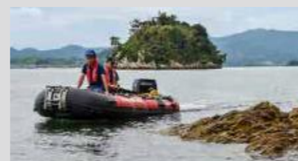
岸壁への接近もペラが無いジェット船外機だから安心
