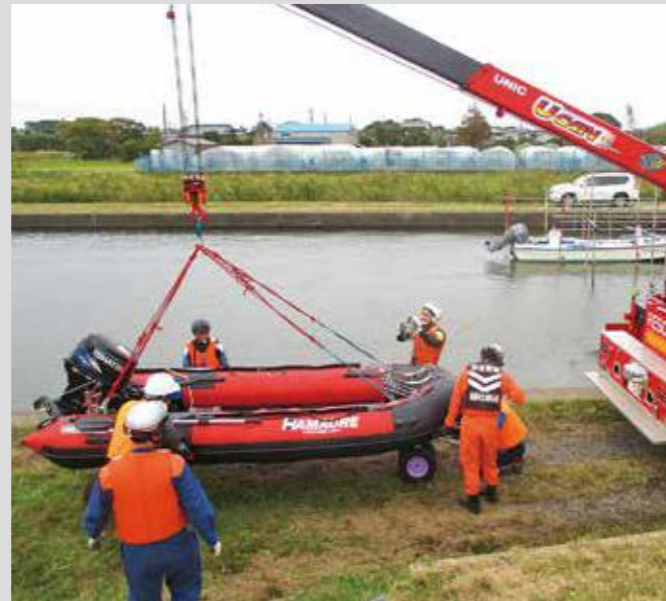
4点吊りのためボートが傾いたりせず安全で手早い吊り上げが可能です
