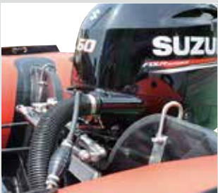
船尾側吊り上げ用金具
