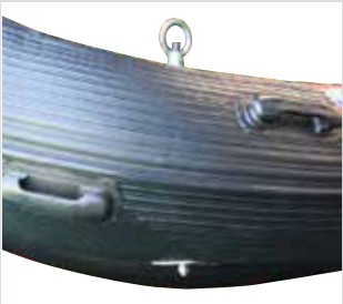
船首側吊り上げ用金具
