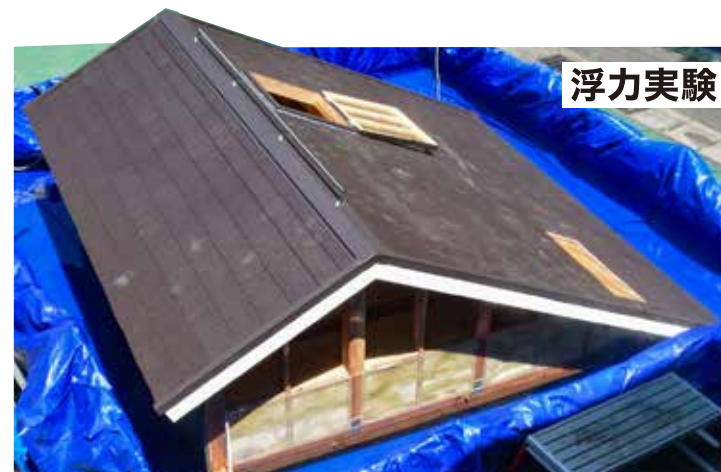
10人入っての浮力実験で余裕の浮力を発揮する、屋根裏シェルター
